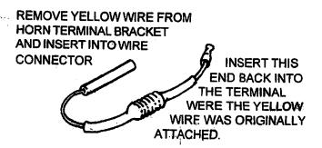
CAREFULLY POSITION RESISTOR INSIDE HORN COVER SO NOTHING TOUCHES THE MOTOR. THE RESISTOR WILL GET HOT WHILE THE HORN HONKS.
